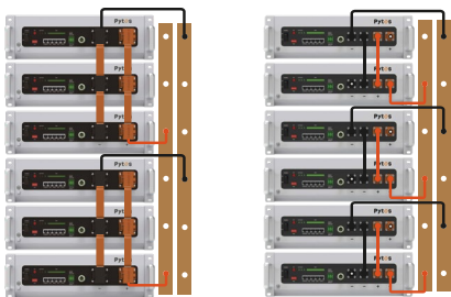
Figura 5-1. Diagrama esquemático de la conexión del cable de alimentación
